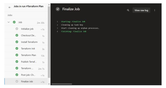
Mediante la tarea "PublishBuildArtifacts@1" estamos generando un artefacto, que contendrá un fichero terraform.tfplan (Salida de Terraform plan). Este fichero está en formato binario y no se puede leer directamente como texto plano. Debemos utilizar comandos específicos de Terraform para mostrar y revisar su contenido de manera legible.
